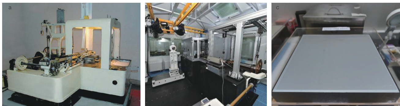
图9 中国第一台光栅刻划机（a）、大型高精度衍射光栅刻划机（b）和中阶梯光栅（c）
