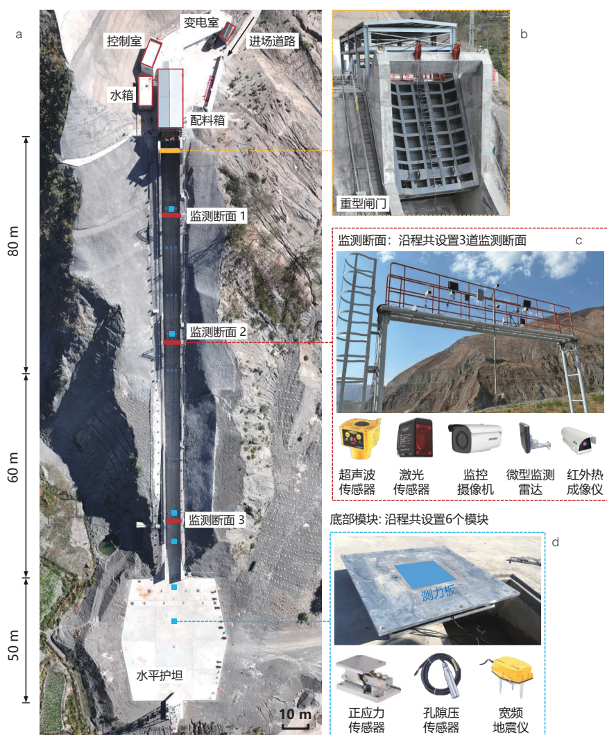
图2 实验平台重要观测断面及仪器布置
