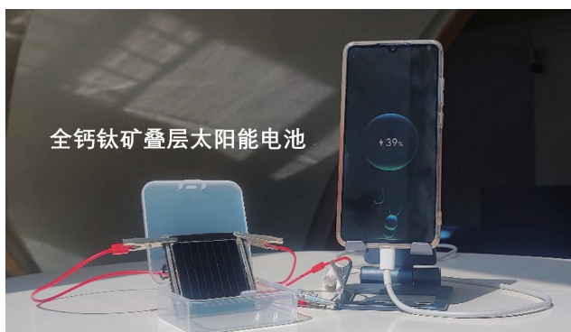
效率创世界纪录的全钙钛矿叠层太阳能电池和组件
