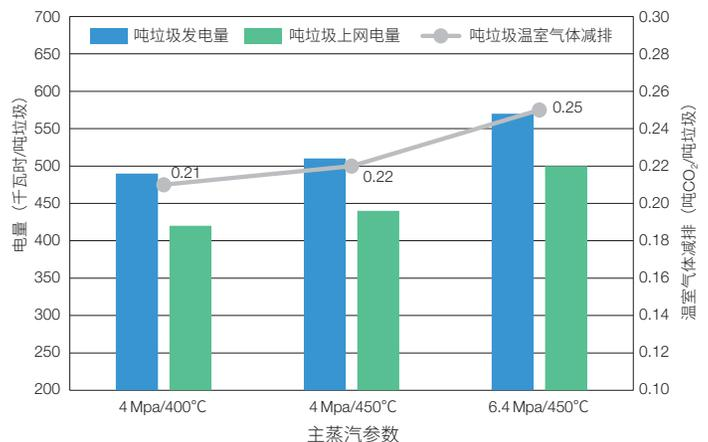
图5 某项目不同蒸汽参数下碳减排量 (CCER)<sup>[8,13,14]</sup>
