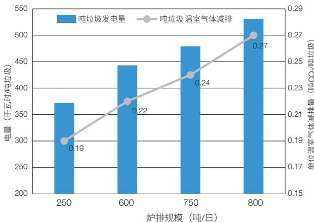
图4 不同单排炉排规模碳减排量对比<sup>[8,13,14]</sup>
