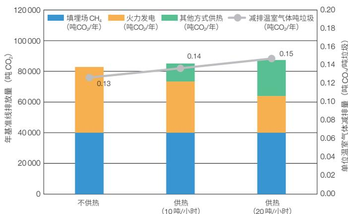
图6 某生活垃圾焚烧厂热电联产基准线碳排放量和碳减排量<sup>[8,13,14]</sup>
