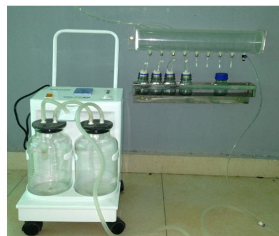
图2 土壤溶液提取系统
