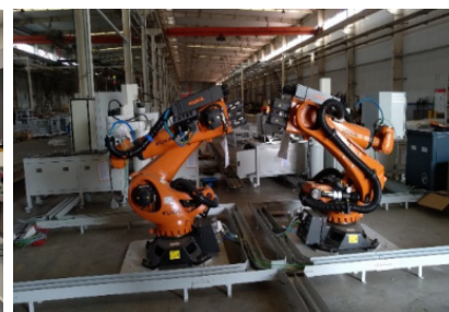
自动化金属板电堆产线
