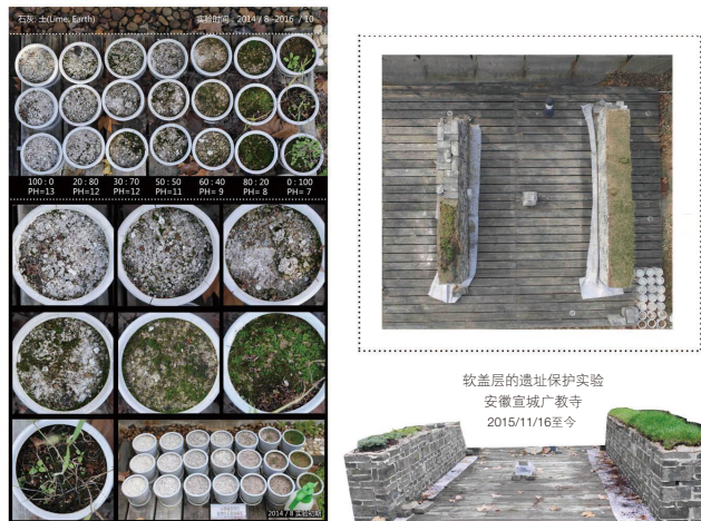
图5 同济大学历史建筑中心实验室 2014 年 8 月开始为阐明屋面苫背材料对屋面耐久性的影响而进行的不同苫背材料植物生长实验（左）；同济大学历史建筑中心实验室 2015 年 11 月为安徽宣城广教寺遗址的保护所进行的“软盖层”保护自然实验研究（右）
