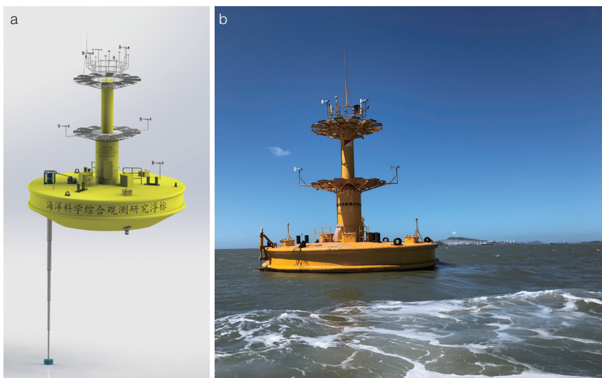
图6 基于大型浮标的自由伸缩式海洋剖面观测系统示意图 (a) 和实际照片 (b)
