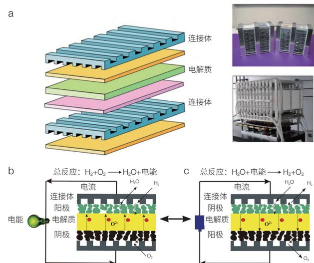
图 4 固体氧化物燃料电池（SOFC）/固体氧化物电解池（SOEC）电堆结构和发电/制氢两种模式工作原理
