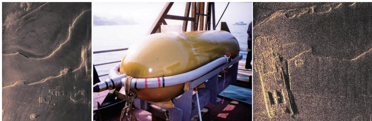
图 3 合成孔径声呐（SAS）所获得的高分辨率海底/沉船图像（中国科学院声学所研制）
