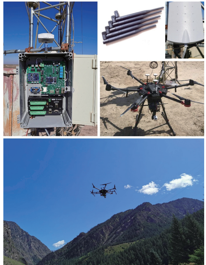
图1 黑河遥感站研发的无人机物联网中继系统采集无网络覆盖观测站点数据示范
